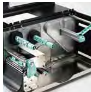
Estructura metálica, tanto la carcasa como el mecanismo de impresión
